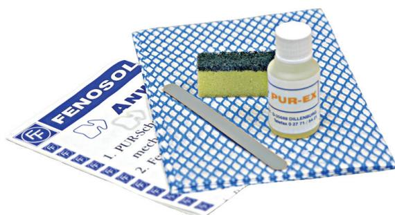
Очиститель Fenosol PUR-Ex применяется для очистки ПВХ-профилей от остатков застывшей пены. Средство наносится с помощью специальной губки. Через 45 мин очиститель удаляется вместе с размягченной пеной с помощью жесткой щетки, губки или лопаточки. При необходимости операцию можно повторить.
